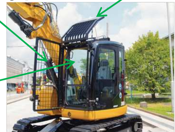
運転室周りの飛来物防護設備の例
